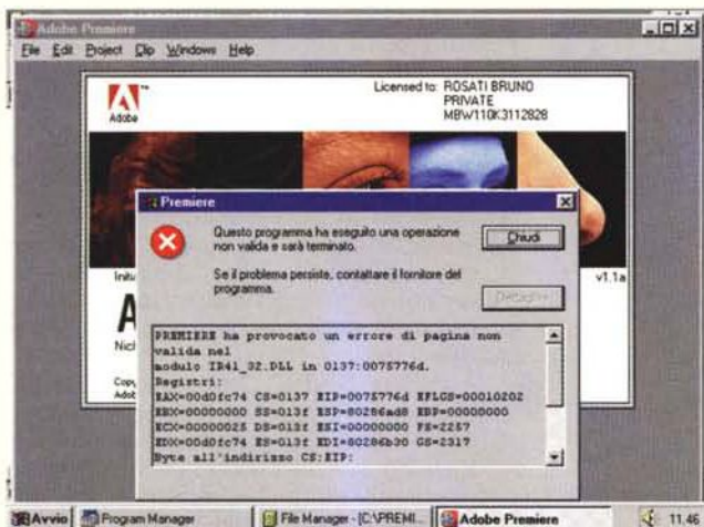
Premiere 1.1 genera un «errore di protezione» se viene tentato di caricarlo con il driver VIDC.IV41 di Indeo Video Interactive. Ciò si produce sia in ambiente Win3.1x che Windows 95.
